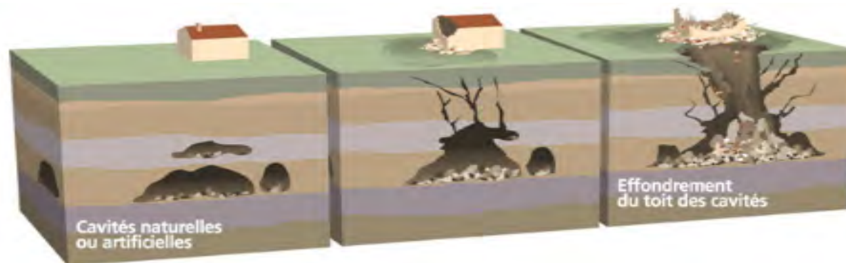
▲ Figure 75 : Manifestation du risque minier - Affaissement de la surface
